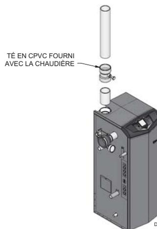
REMARQUE : LE TUYAU ET LES RACCORDS DE VENTILATION DOIVENT ÊTRE UTILISÉS DANS LES INSTALLATIONS EN PLACARD OU EN ALCÔVE.
